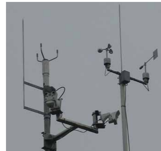
Slika 16. Ultrazvočni (levo) in anemometer s čašicami za meritev hitrosti in smeri vetra v Murski Soboti, september 2009. Pod ultrazvočnim anemometrom sta kameri (vir: arhiv ARSO)
