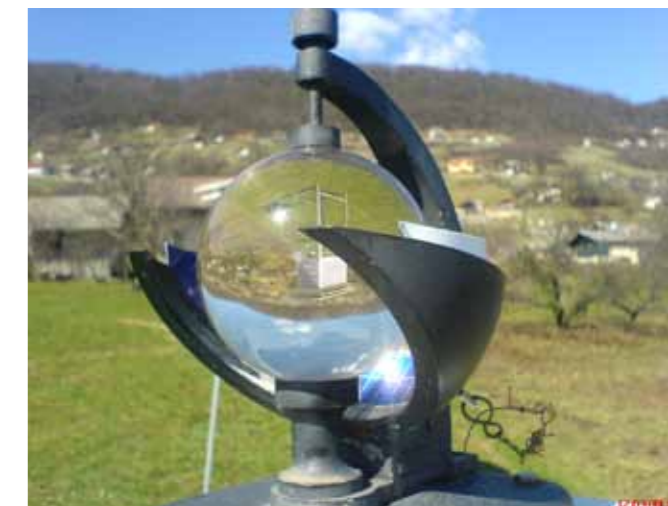
Slika 14. Heliograf na postaji Semič, marec 2009. Sonce na traku izžiga sled (vir: arhiv ARSO)
