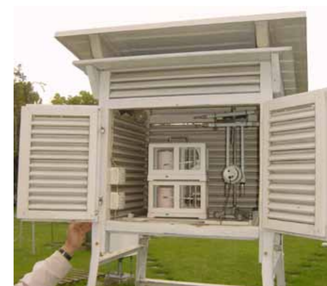
Slika 10. Meteorološka hišica s termometri, termografom in higrorafom na postaji Ljubljana Bežigrad, oktober 2007 (vir: arhiv ARSO)
