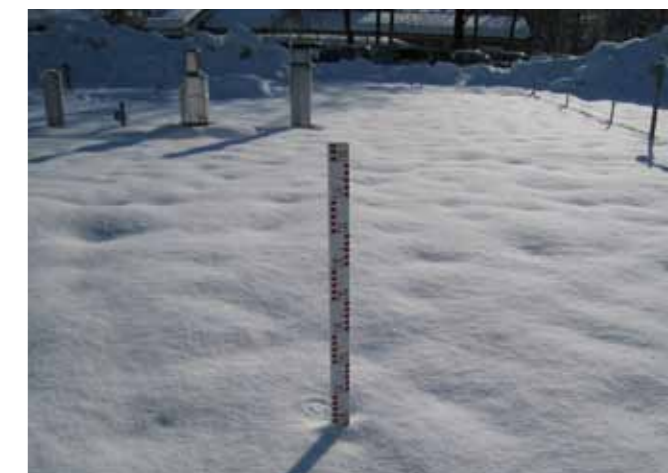
Slika 13. Snegomer za merjenje snežne odeje na postaji Ljubljana Bežigrad, februar 2010 (vir: arhiv ARSO)
