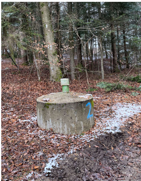
Slika 2. Merilni objekt za ocenjevanje stanja podzemne vode v okolici Tenetiš, 1. marec 2023 (Foto: U. Pavlič) Figure 2. Groundwater status measuring object near Tenetiše, 1 st of March 2023 (Photo: U. Pavlič)
