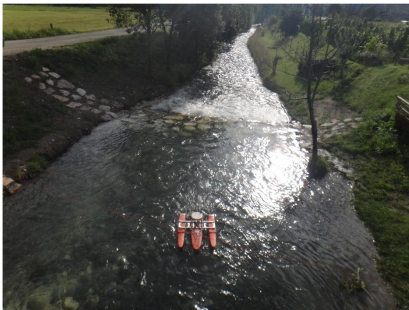
Slika 2. Meritev pretoka povirnega dela Save Dolinke v avgustu 2014 (Foto: Arhiv ARSO)
