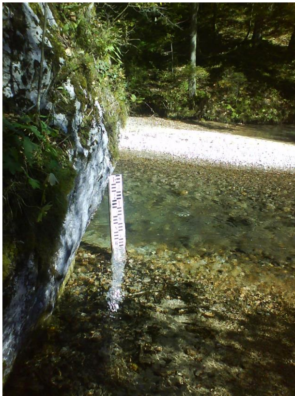
Slika 2. Merilno mesto na izviru Kamniške Bistrice – oktober 2008 (Foto: M. Hočevnar) Figure 2. Gauging station at Kamniška Bistrica spring – October 2008 (Photo: M. Hočevnar)
