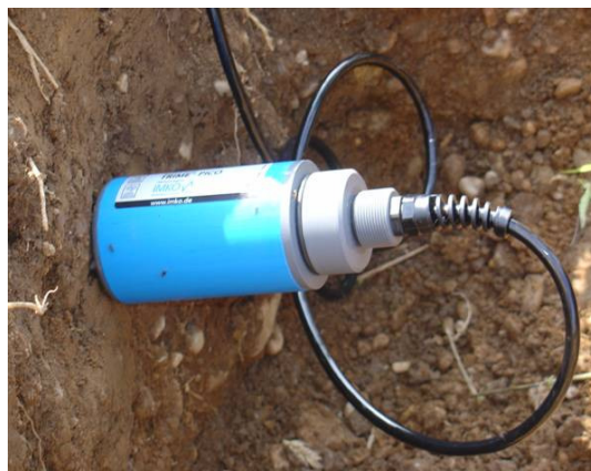
Slika 2: Merilnik TRIME-EZ, nameščen v tleh.
