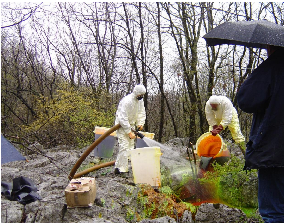
Sledilni poskus na Krasu Tracing experiment on Karst
