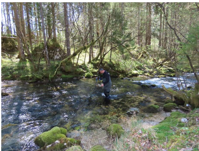
Slika 1. Meritev pretoka izvira Kamniške Bistrice v aprilu 2020 Figure 1. Discharge measurement of Kamniška Bistrica spring in April 2020
