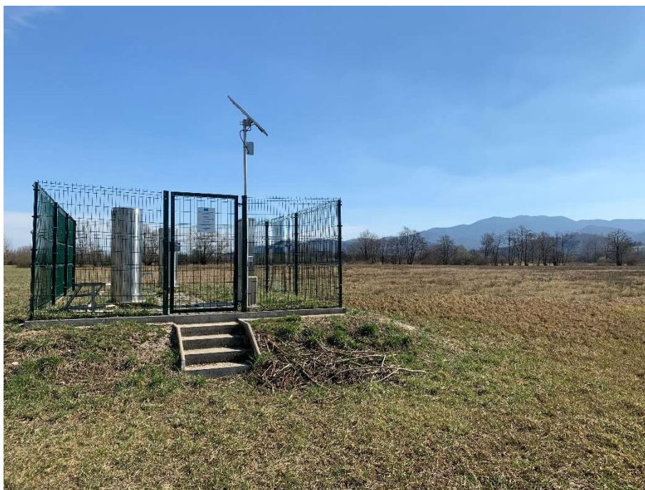
Slika 2. Merilna postaja za spremljanje stanja podzemne vode v Bevkah na Ljubljanskem Barju (12. marec 2020) Figure 2. Bevke Measuring station for groundwater status observation of Ljubljansko Barje (12th of March 2020)
