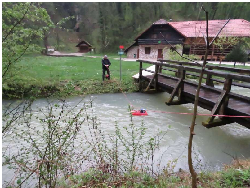
Slika 2. Izvajanje meritev pretoka na območju izvira Studene v Globočicah v času nadpovprečne izdatnosti aprila 2019 (Arhiv ARSO)
