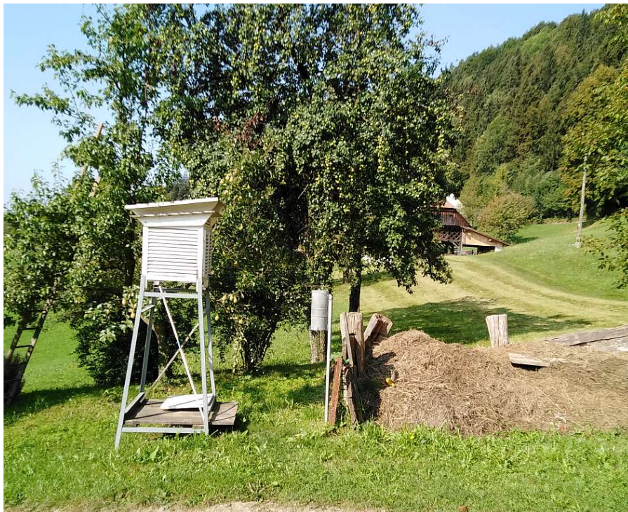
Slika 2. Padavinska postaja in elektronski zapisovalnik temperature in vlažnosti zraka (v meteorološki hišici) v Čemšeniku, slikano septembra 2020 (vir: arhiv ARSO)
